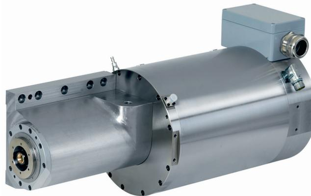
5 Motorspindel TSE 260-5000/32 für die Zahradbearbeitung mit einer S1-Leistung von 32 kW im Drehzahlbereich von 1695 bis 3375 min<sup>-1</sup>
