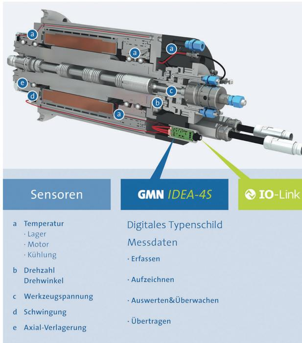
3 Idea-4S ermittelt Daten auf einfache Weise, bereitet sie auf, überwacht sie und stellt sie mittels bidirektionaler Signale über digitale Schnittstellen für den Austausch und die Kommunikation in Produktionsnetzwerken bereit. Mit dem Beginn der Datenauswertung zur Performance-Steigerung erklimmt Idea-4S eine höhere Stufe der Nutzung © GMN
